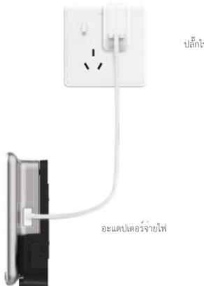
เชื่อมต่อแหล่งไฟกับบอร์ดหลักของเดปต์อร์จ่ายไฟ (5 โวลต์ 2 แอมป์ จ้าวนายแยกต่างหาก)
